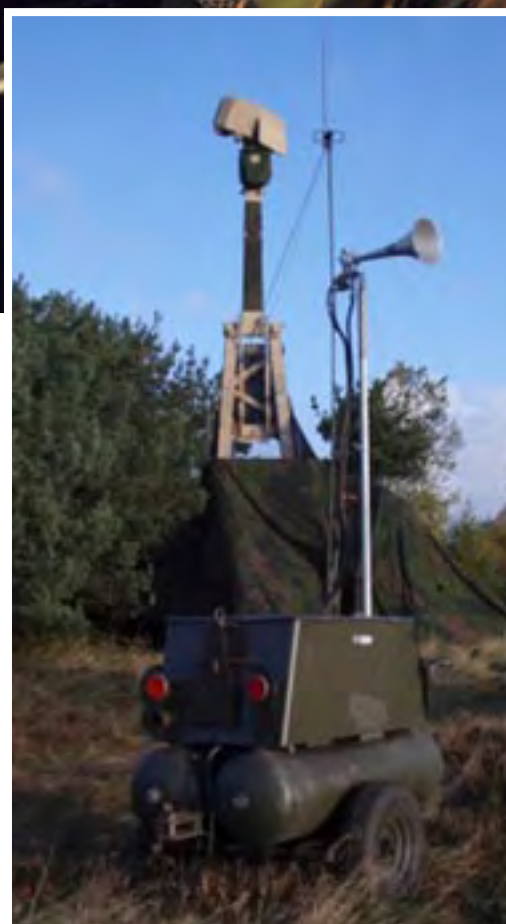
UndE 23 med larmaggregat för att kunna varna för RAM-mål
