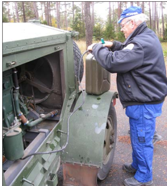
Bertil kopplar bensinen direkt till motorn, slang för ändamålet fanns behändigt på en kp-bil i förrådet.
