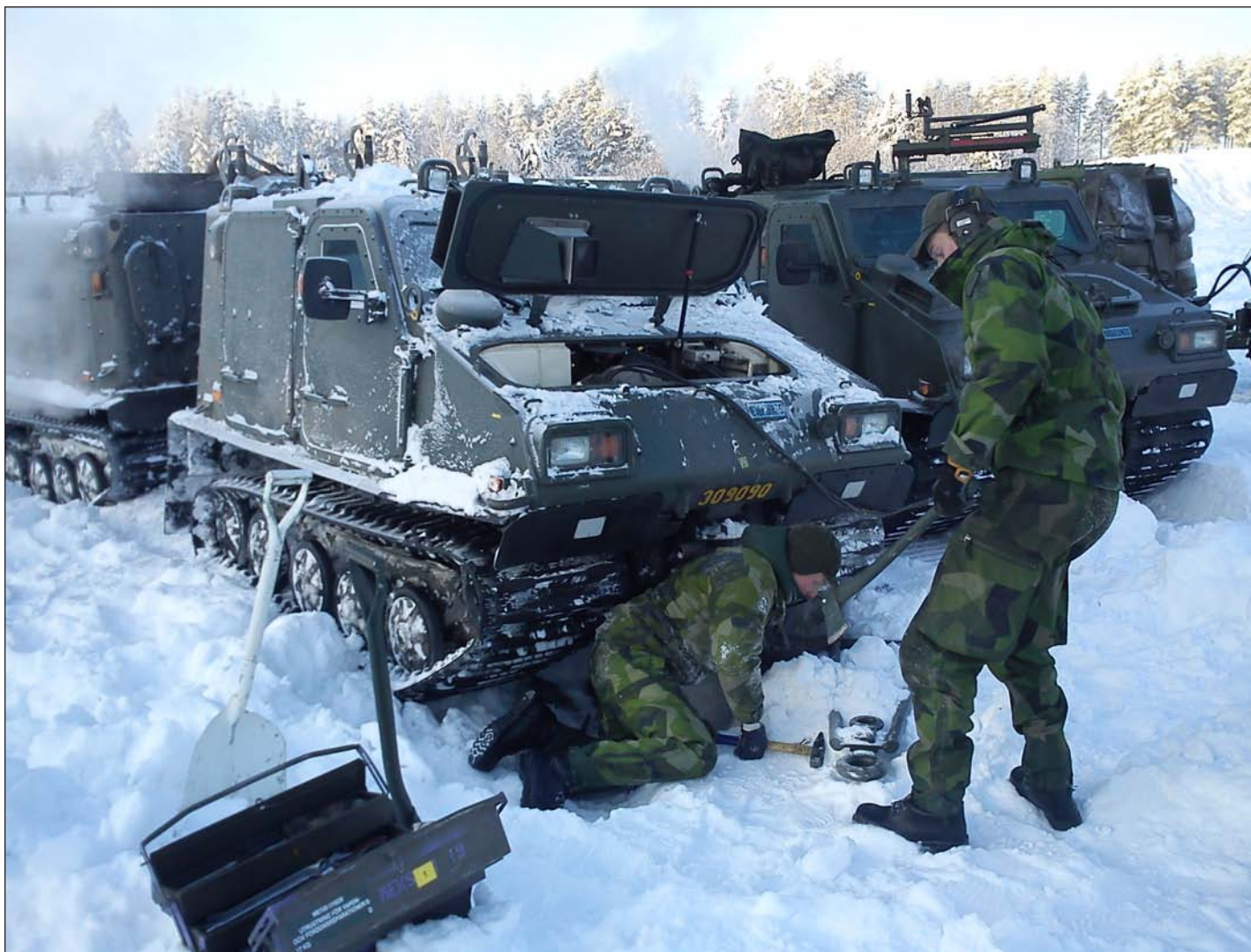
Haveri på drivaxeln på bandvagnen som bataljonen använde sig av. Termometern visade -25
