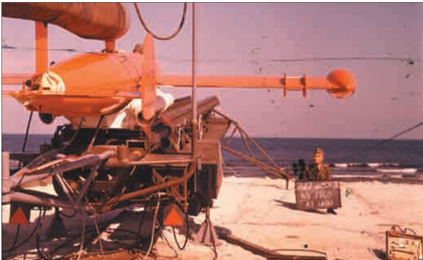
Roboten är en CT 10, nr 321:IV, med krutmotor klar för avfyrning den 16 augusti 1960 kl 1000 (troligen fransk teknik som håller skylten).
